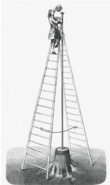
Fig. 61. — Paradoxe hydrostatique, crève-tonneau de Pascal.
